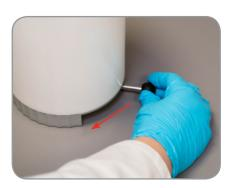
Die Abgabekruke mit Hilfe der easylock Funktion an der Basisplatte fixieren.
