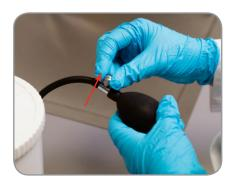
Die Feststellschraube am Pumpball schließen (im Uhrzeigersinn).
