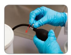
Die Feststellschraube wird gelöst (wichtig!) und die Kruke kann abgeschraubt und gewogen werden.
