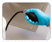
Durch wiederholtes Drücken des Pumpballs wird der Boden der Abgabekruke nach oben geschoben. Die zu befüllende Kruke wird gefüllt.
